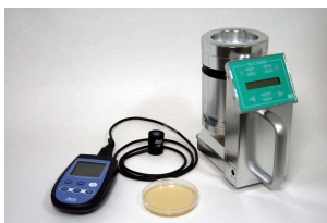
写真1: UVC測定器とエアサンプラー
